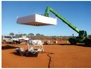
図 6.10 PAF の雑音温度計測 [33]
