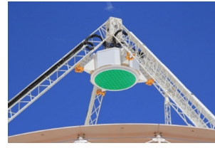
図 6.3 ASKAP アンテナに搭載された Checkboard PAF[28]
