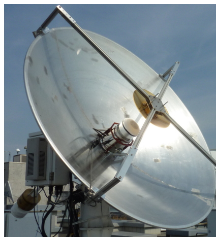
図 5.7 小金井 2 号館屋上に設置した 2.4m 小型可 搬局 MARBLE
