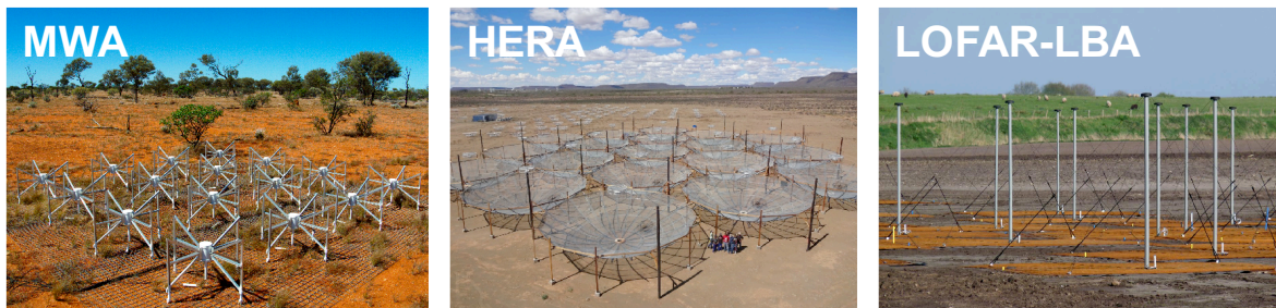
図 2.7 フェーズドアレイ技術を用いた電波天文施設。左からオーストラリアの MWA、南アフリカの HERA、ヨーロッパの LOFAR Low Band Antenna。
